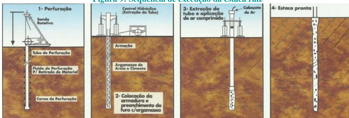
Figura 9: Sequência de execução da estaca raiz
