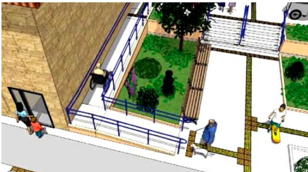
Figura 03 – Sinalização tátil de alerta e direcional em rota acessível
