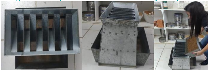
Figura 4: Redução do tamanho das amostras pelo separador
