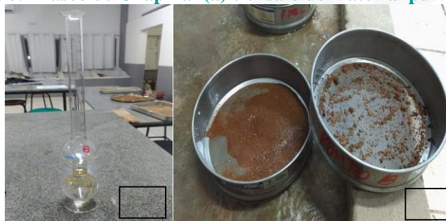
Figura 6: Frasco de Chapman(a) e ensaio de material pulverulento
