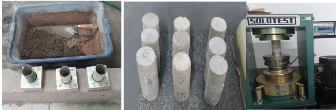
Figura 8: Mistura da argamassa
