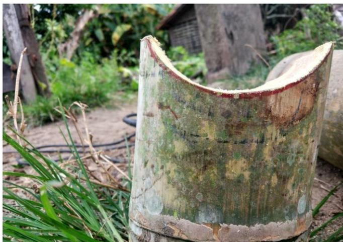
**Figuras 9:** Corte estilo “boca de peixe” para encaixe das peças
