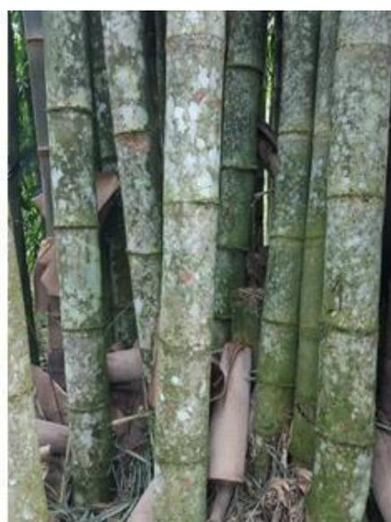
**Figuras 7 e 8:** Proteção Caulinar ou bainha caulinar (Figura 7), Fungos e manchas que indicam que o bambu possui mais idade (Figura 8).
