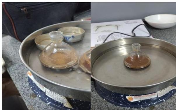
**Figuras 4 e 5:** Nas imagens, os picnômetros posto a ensaio.
