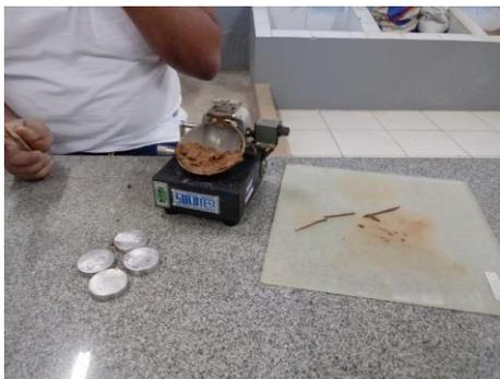
**Figura 8:** Ensaio de Liquidez e Plasticidade.
