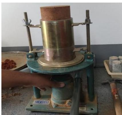
**Figuras 9:** Ensaio de Proctor em execução.
