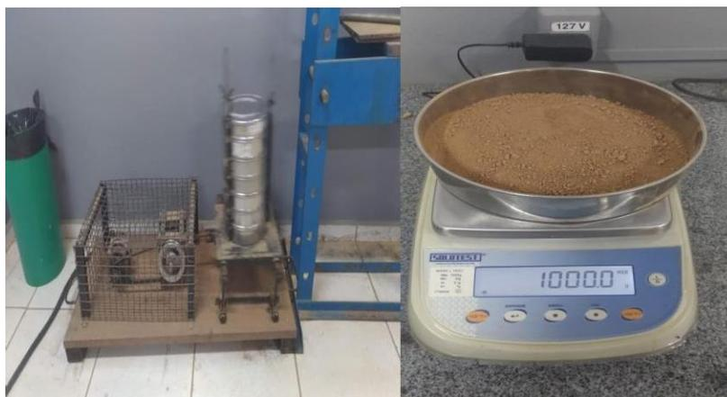
**Figuras 6 e 7:** Ensaio de Análise Granulométrica por peneiramento.
