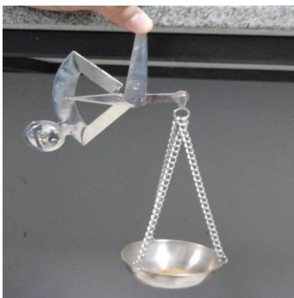
**Figura 3:** Pesagem do solo para realização do ensaio de Speed Test.
