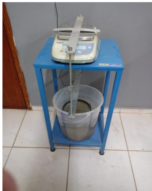
Figuras 03 e 04: Ensaio na balança Hidrostática. Fonte: Autor, 2019
