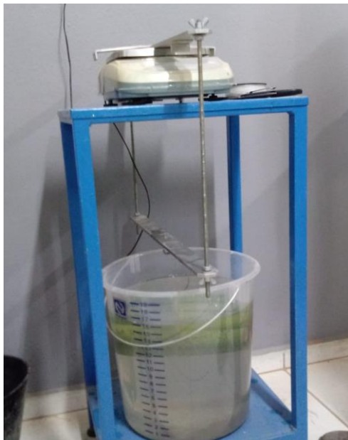
Figuras 03 e 04: Ensaio na balança Hidrostática. Fonte: Autor, 2019
