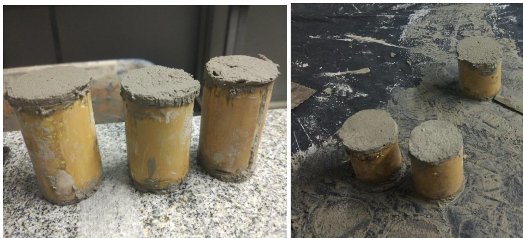
Figuras 01 e 02: Corpos de prova preenchidos com argamassa.
