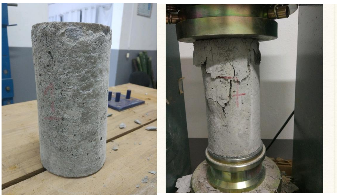
Figuras 09 e 10: Corpos de prova de concreto (Figura 5), corpo de prova de concreto em ensaio de Resistência a Compressão (Figura 6).
