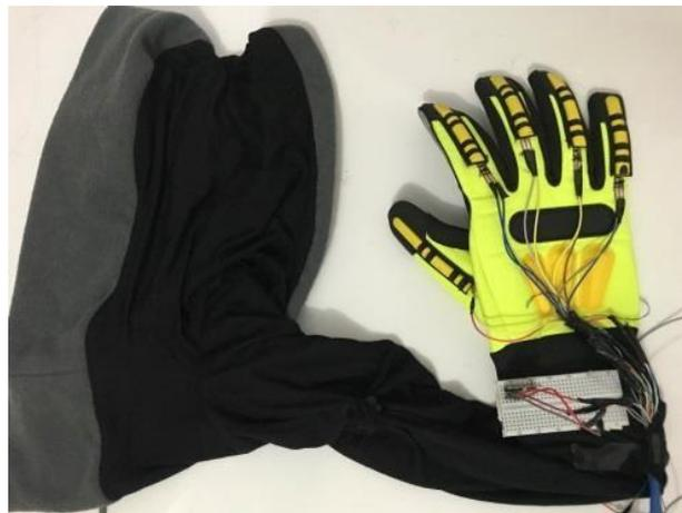
**Figura 1 - Fixação do Sensores Flex na Luva**
