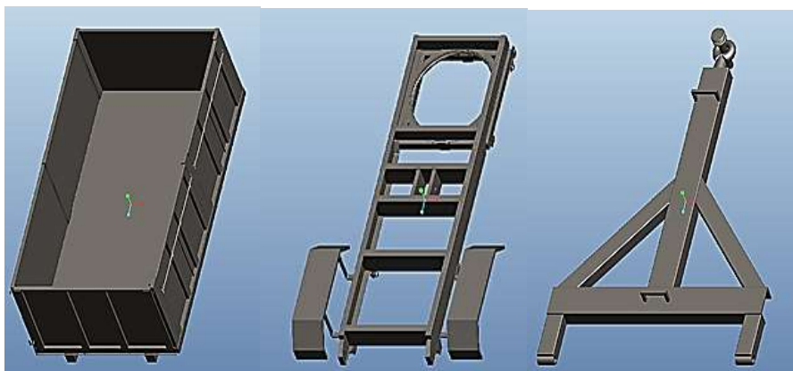
Figura 02 - Submontagem da carroceria, da carreta e do chassi da carreta.
