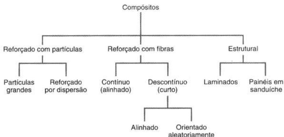
**Figura 1** - Um esquema de classificação para vários tipos de compósitos
