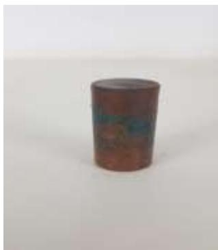
**Figura 05 – SAE 1045 ao fim do ensaio**
