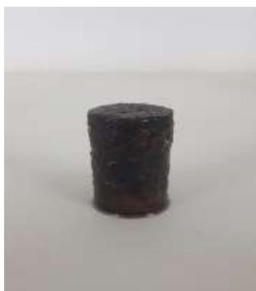
**Figura 06 – SAE 1020 ao fim do ensaio**
