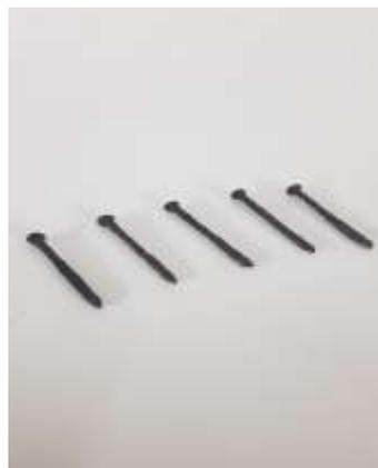
**Figura 04 - SAE 1008 ao fim do ensaio**
