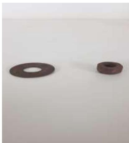
**Figura 03** – ASTM A36 ao fim do ensaio
