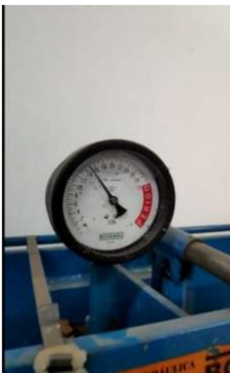
Figura 9 – Medidor da prensa Hidráulica
