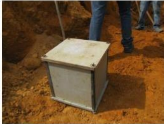
Figura 3 - Amostra indeformada acondicionada para o transporte (Poerschke, 2016).
