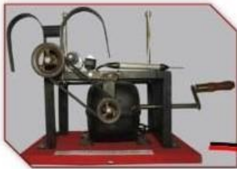
Figura1: Em 1932, nos Estados Unidos, Albert Hyman, utilizou um gerador de pulsos movido a manivela e um cabo-eletrodo bipolar introduzido diretamente no tórax para promover estimulação cardíaca. Estabeleceu o conceito "PACE". Disponível em: https://abecdeca.org.br/museu/ . Acessado em 28 mai 2019.
