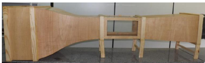
Figura 1 - Túnel de vento montado
