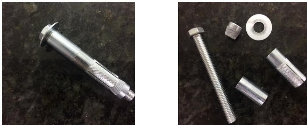
Figura 03 –Chumbador usado no ensaio Fonte: Acervo do autor.
