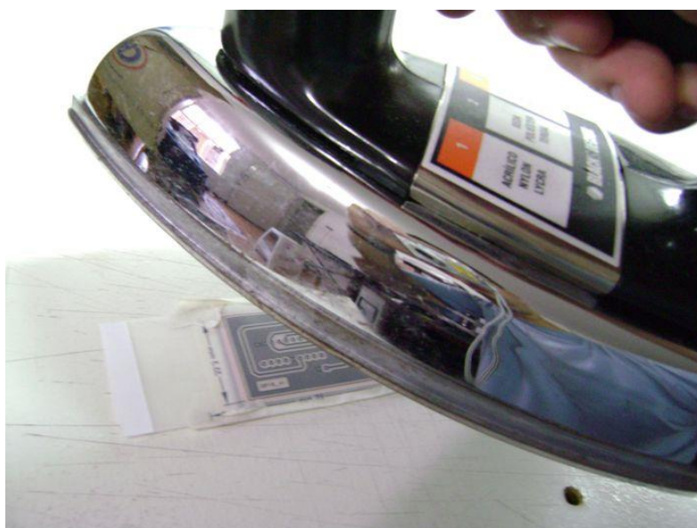
Figura 3.7: Transferência térmica (Ferro de passar roupa)
