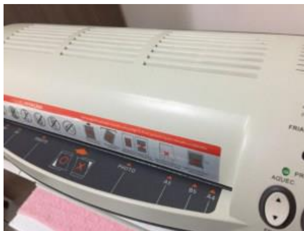
Figura 3.11: Transferência térmica por plastificadora
