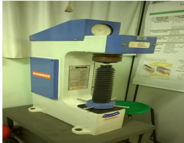
**Figura 9 - Durômetro de bancada**
