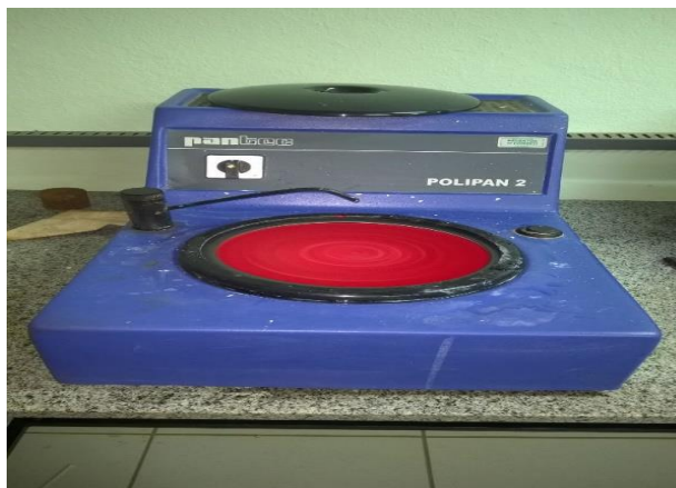
Figura 10 - Máquina de polimento PANTEC com capacidade de rotação de 300 ou 600RPM
