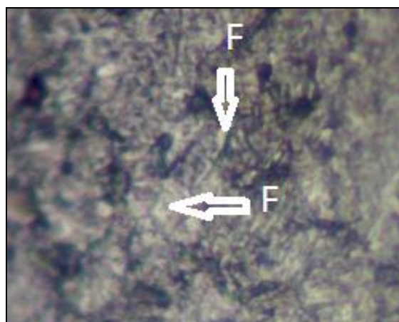
Figura 12. Micrografia da amostra resfriada em água, F= Ferrita
