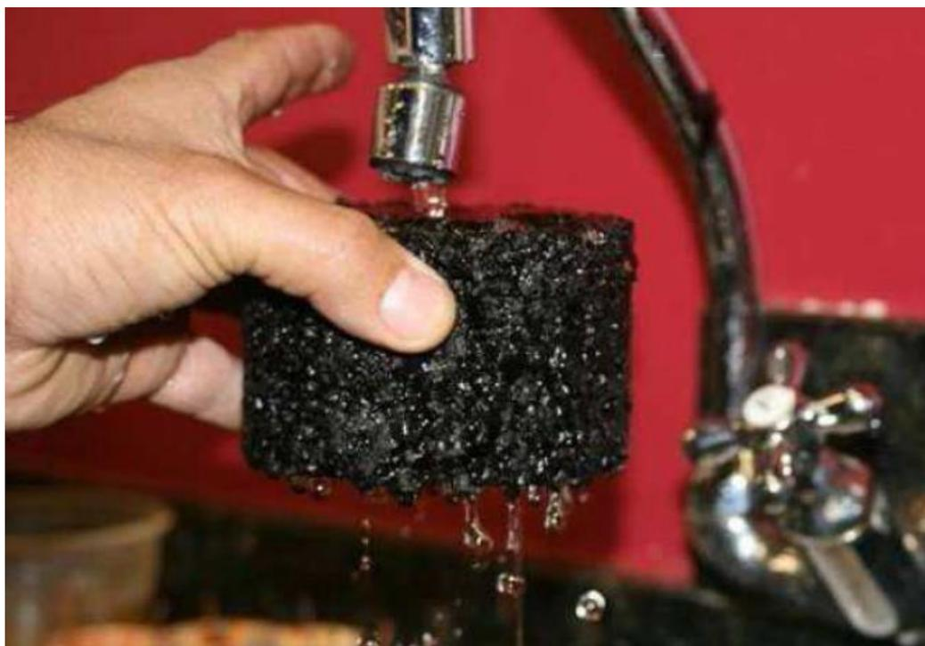
**Figura 1 – Escoamento de água pelo revestimento CPA**
