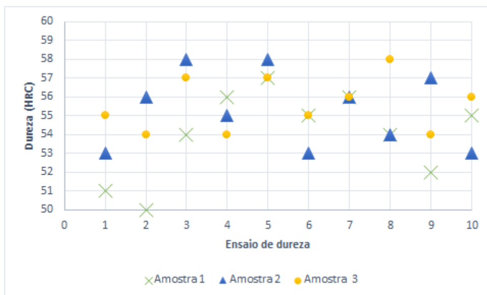
Figura 4: Dureza das amostras do grupo 4 após passarem por tratamento térmico de têmpera de 90 minutos e revenimento de 40 minutos.
