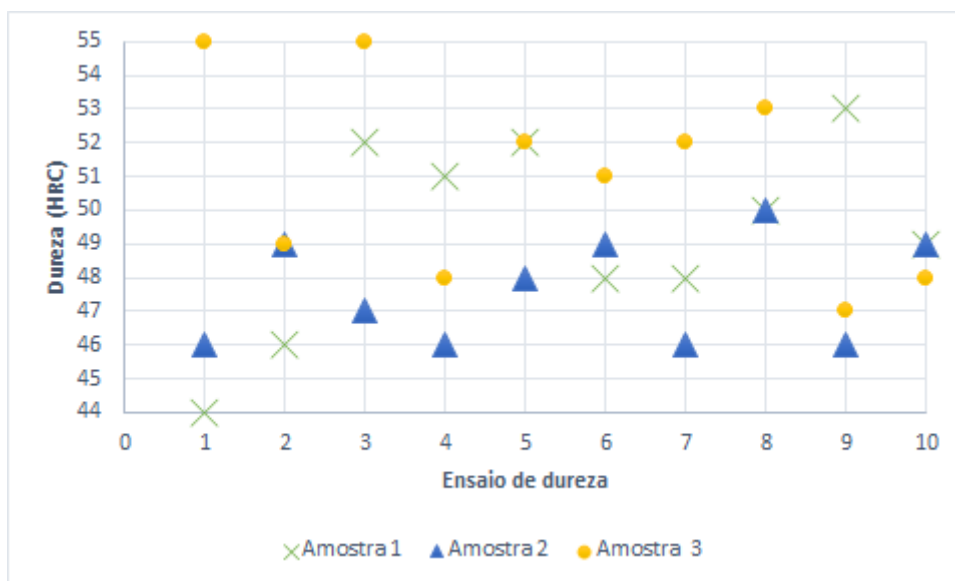
Figura 3: Dureza das amostras do grupo 3 após passarem por tratamento térmico de têmpera de 60 minutos e revenimento de 40 minutos.
