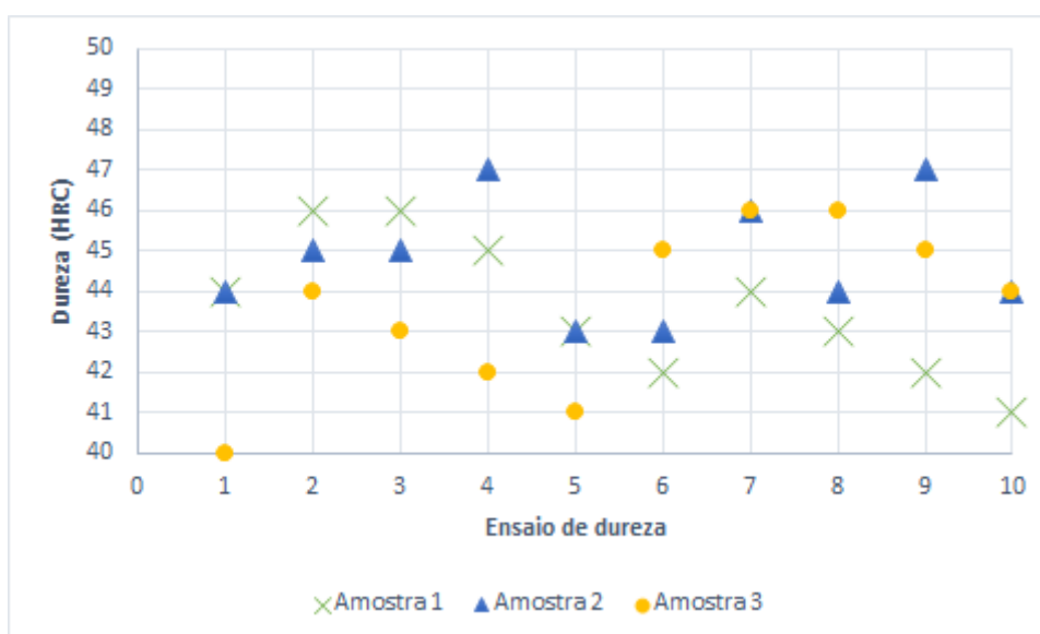
Figura 2: Dureza das amostras do grupo 2 após passarem por tratamento térmico de tempera de 30 minutos e revenimento de 40 minutos.
