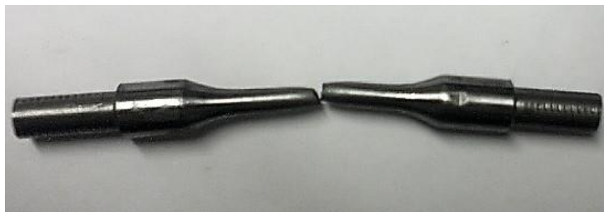
Figura 2: Corpo de prova após o ensaio de tração
