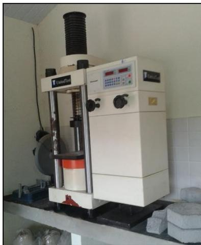
**Figura 07 – Prensa utilizada para ensaio de compressão dos corpos de prova.**
