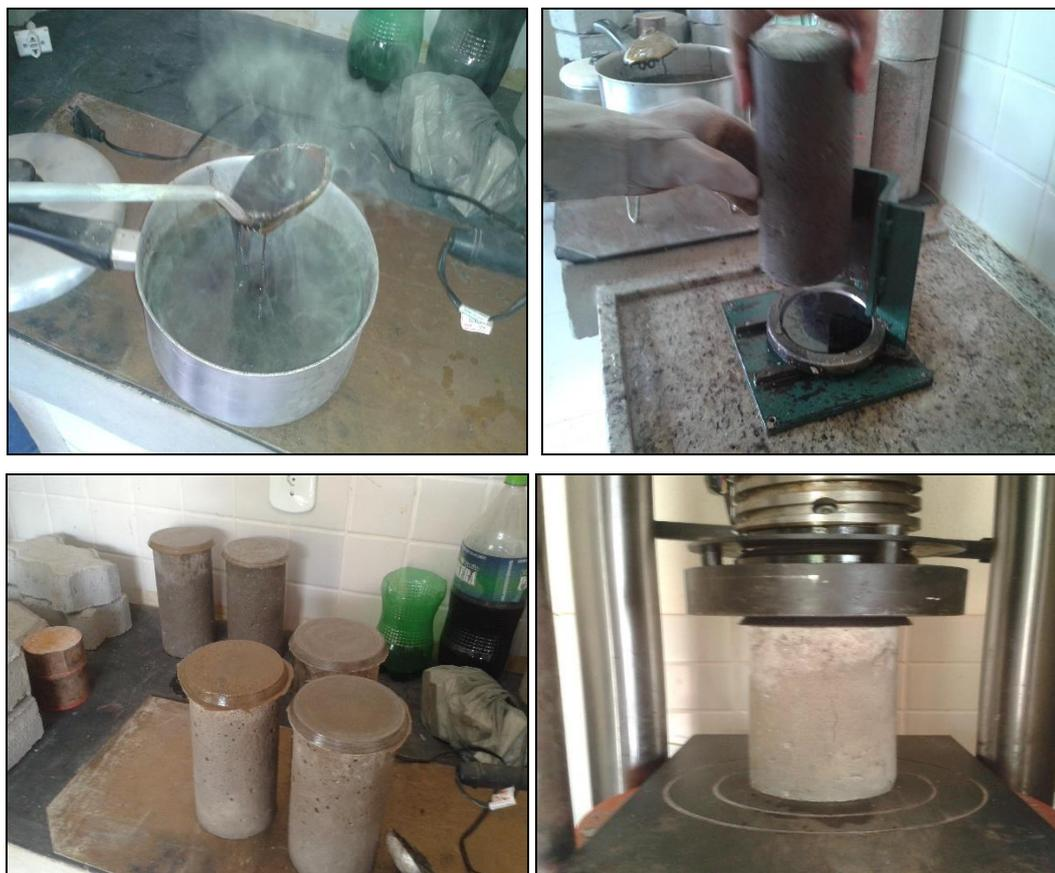
**Figura 08 – Capeamento e rompimento dos corpos de prova do concreto.**
