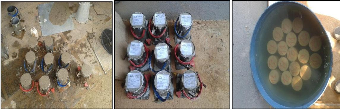
**Figura 06 – Pesagem, mistura, Slup Test, moldagem e cura dos corpos de prova.**
